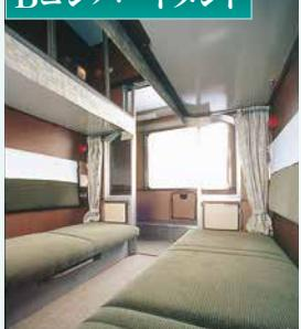
▲他の寝台特急B寝台と基本的に同じ構造で、左右上下2段、計4つの寝台があり、昼間時は下段寝台2つを座席として利用します。
