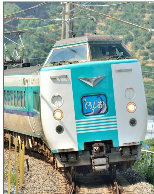
381系電車(写真はくろしお号)
